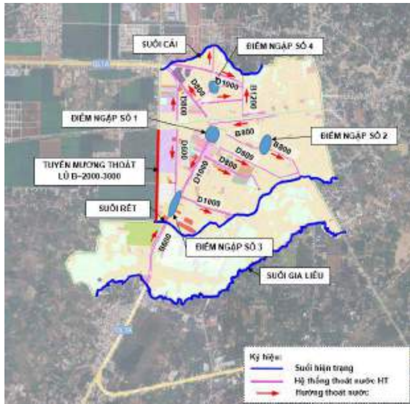
Hình 42: Hiện trạng hệ thống thoát nước mưa
